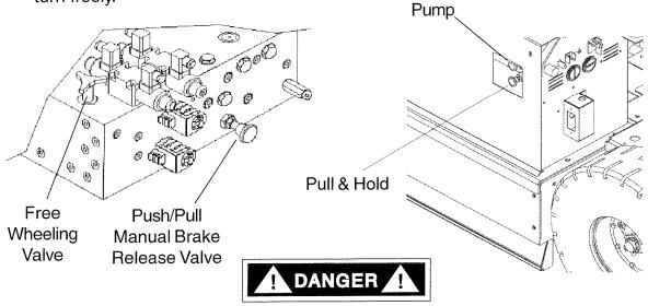
AFTER RELEASING THE BRAKES, THERE IS NOTHING TO STOP THE MACHINE'S TRAVEL. MACHINE WILL ROLL FREELY ON SLOPES. BE ON GUARD AGAINST RUNAWAY. DO NOT DRIVE MACHINE WITH BRAKES RELEASED.
