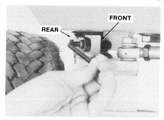
Figure 37. Steering Stop Bolt.
